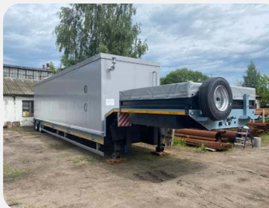
Мобильные аварийные котельные теплопроизводительностью 2 МВт на дизельном топливе с возможностью быстрого присоединения к теплотрассе
