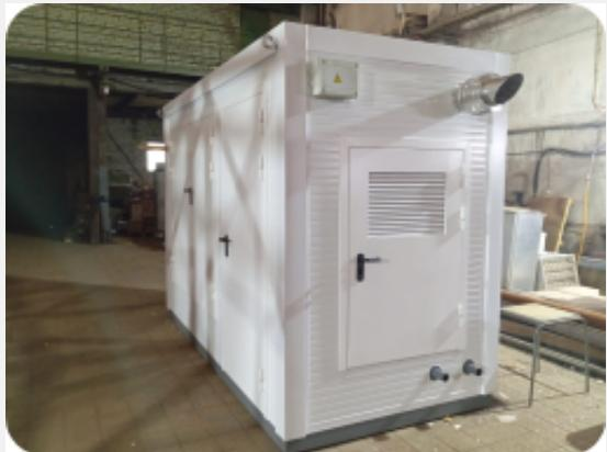
Термомодули производительностью до 1000 кВт на природном газе с антифризом во внутреннем контуре теплоснабжения, способен отапливать 10 тысяч квадратных метров площадей
